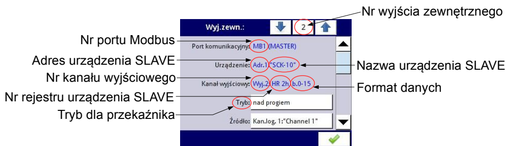
Rys. 7.107. Widok przykładowego Wyjścia zewnętrznego w konfiguracji jako przekaźnik
