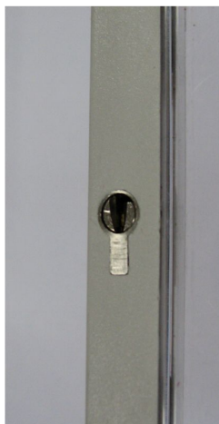
Rys. 4.5. Sposób montażu wkładki do zamka w obudowie
