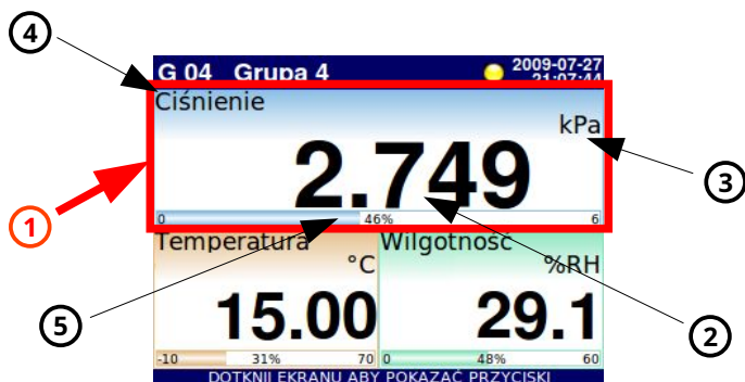
Rys. 6.8. Struktura Panelu pomiarowego
