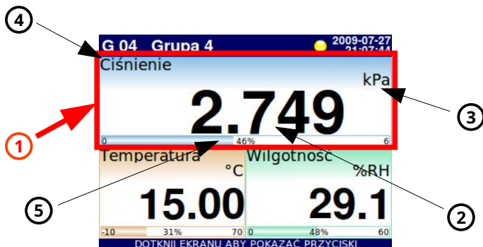
Rys. 6.8. Struktura Panelu pomiarowego
