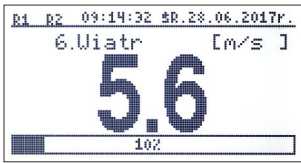
Aktualna wartość sygnału pomiarowego wysokość cyfr 18mm
